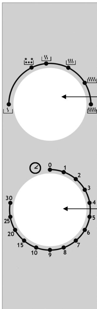
**A - Régulateur du niveau de puissance****6 niveaux de puissance**
