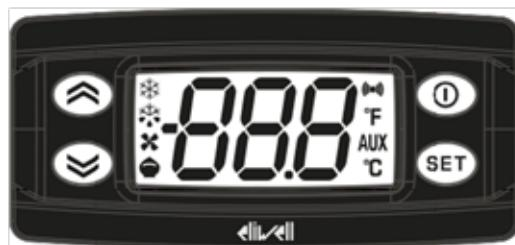
El termostato ya está programado para este aparato. En la mayoría de los casos, no es necesario ajustar las posiciones. Al encender el aparato, el display/pantalla mostrará la temperatura actual en el aparato.
