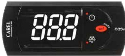
Der Regler ist voreingestellt für den Schrank und normalerweise es ist nicht notwendig die Einstellung zu regulieren. Bei Anschließen zeigt das Display die aktuelle Temperatur im Schrank.
